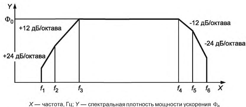
Рисунок 5 — Форма спектральной мощности ускорения для гидравлического вибростенда (по ИСО 8626)
