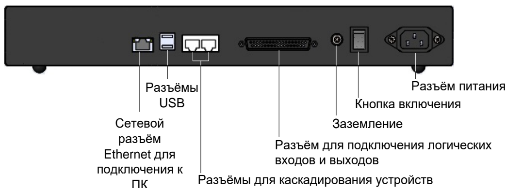
Рис. 2 Задняя панель контроллера «BC-301»
