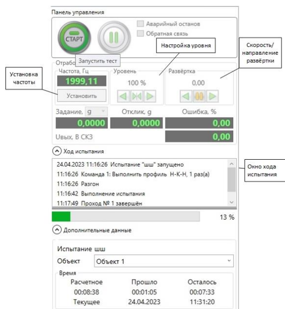
Рис. 34 Вид панели управления для испытания синусоидальным сигналом.
